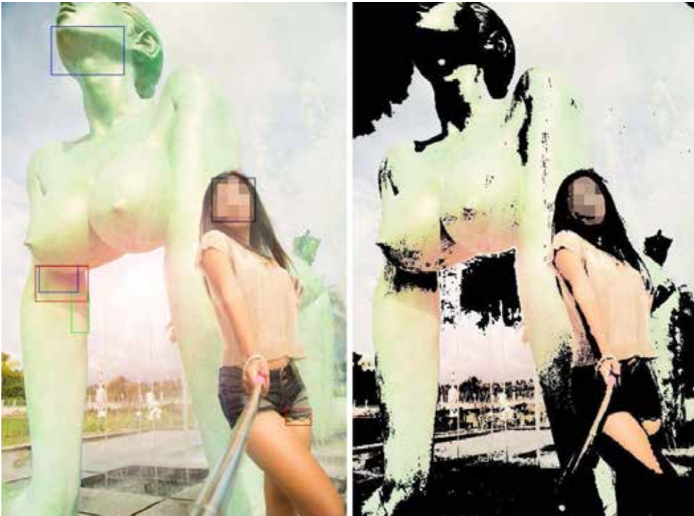
Abbildung 5.4: Links: Eine gescheiterte Gesichtserkennung. Auf dem Bild wurden verschiedene Bereiche falsch als Gesichtspartien erkannt, dementsprechend liegt der grüne Rahmen mit der vermeintlichen Nasenpartie in einem zufälligen Bereich. Rechts: Die Filterung scheitert hier dementsprechend, es werden nur wenige Teile des Bildes herausgefiltert.
